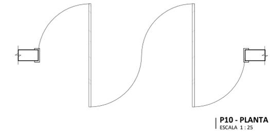
PORTA PIVOTANTE 2 FOLHAS VIDRO CAIXILHADO - LAMINADO 10mm INCOLOR - TRATAMENTO ANODIZADO FOSCO - PUXADOR TUBULAR
