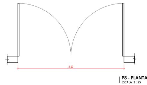
PORTA DE ABRIR COM 2 FOLHAS DE VIDRO - 2 PLANOS COM 10MM - PERFIS CENTRAIS COM REFORÇO INTERNO E EXTERNO - FECHADURA COM CHAVE TETRA - PUXADOR TUBULAR - ARREMATE NA FACE INTERNA COM 60MM - ACESSÓRIOS EUROPEUS MRODRIGUES E ROTO-FERMAX
